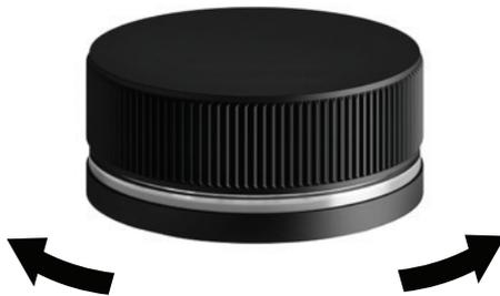
Nach der erstmaligen Aktivierung des digitalen Waschtischmischers ist eine Temperatur von 38° voreingestellt. Durch das Drehen des Bedienelementes im Uhrzeigersinn wird die Temperatur erhöht, durch das entgegengesetzte Drehen wird die Temperatur entsprechend gesenkt. Die maximal einstellbare Temperatur beträgt 46°. Die Farbe des LED-Rings passt sich der gewählten Temperatur an.
