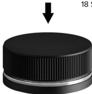
Um den digitalen Waschtischmischer auf die Werkseinstellungen zurückzusetzen (Wassertemperatur: 38°, Wassermenge: L4, deaktivierte Timer-Funktion), wird das Bedienelement für 18 Sekunden gedrückt gehalten, bis der LED-Ring in Gelb aufblinkt.
