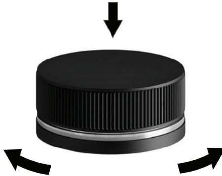
Werkseitig ist eine Wassermenge L4 voreingestellt. Zur Erhöhung bzw. Verringerung der Wassermenge wird das Bedienelement gedreht während dieses gleichzeitig gedrückt gehalten wird. Durch das Drehen des Bedienelements im Uhrzeigersinn wird die Wassermenge erhöht, durch das entgegengesetzte Drehen wird die Wassermenge entsprechend verringert. Es stehen insgesamt acht Einstellungsoptionen zur Verfügung (L1 bis L8).
