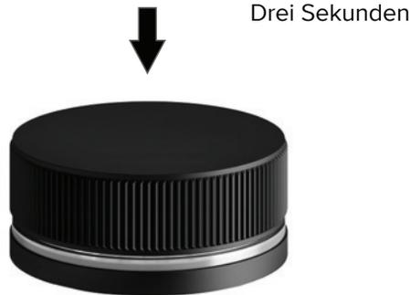
Durch die Memory-Funktion der Armatur kann eine präferierte Wassermenge gespeichert werden, sodass diese Menge nach der erneuten Aktivierung des Waschtischmischers direkt verfügbar ist. Hierzu wird nach der Aktivierung des Waschtischmischers zunächst die gewünschte Wassermenge ausgewählt. Wird nun das Bedienelement für drei Sekunden gedrückt gehalten, so erfolgt die Speicherung dieser Menge. Der LED-Ring blinkt hierbei kurz auf.
