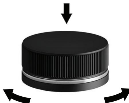
Werkseitig ist eine Wassermenge L4 voreingestellt. Zur Erhöhung bzw. Verringerung der Wassermenge wird das Bedienelement gedreht während dieses gleichzeitig gedrückt gehalten wird. Durch das Drehen des Bedienelementes im Uhrzeigersinn wird die Wassermenge erhöht, durch das entgegengesetzte Drehen wird die Wassermenge entsprechend verringert. Es stehen insgesamt acht Einstellungsoptionen zur Verfügung (L1 bis L8).
